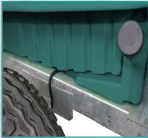
Rezervoar za pranje sistema Circuit washing tank
