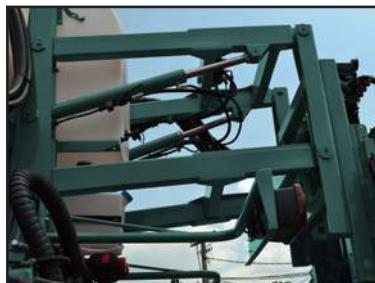
Paralelogram grane sa hidrauličnim podizanjem, 1900mm
